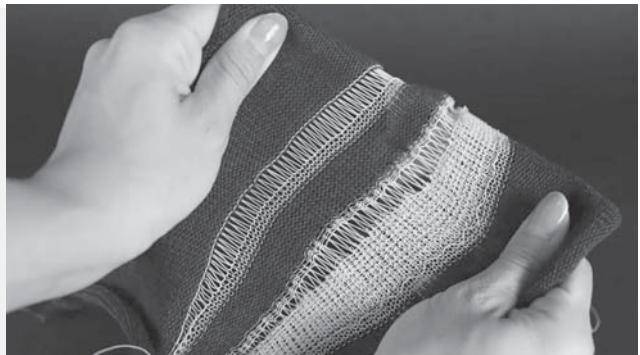
محققان موسسه فناوری ماساچوست (MIT) موفق به توسعه الیاف هوشمند تغییر شکل دهنده و قابل برنامه‌ریزی با نام FibreRobo شده‌اند. این الیاف در واقع الاستومرهای بلور مایع هستند. ساختار پوشک اتفاقی شده از این الیاف به گونه‌ای خواهد بود که در دماهای پایین تر می‌توانند به صورت عایق عمل کنند و بر عکس آن را نیز در دماهای بالاتر انجام دهند.
